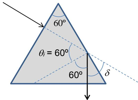
Primero calculamos el ángulo límite para la reflexión total, para saber si puede haber refracción en la segunda cara del prisma
