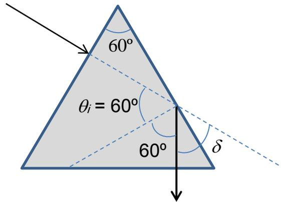
Primero calculamos el ángulo límite para la reflexión total, para saber si puede haber refracción en la segunda cara del prisma
