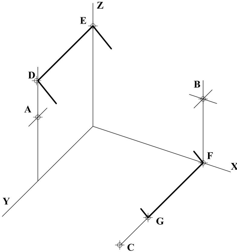
**B4.-** Representar en diédrico, dando las vistas que se consideren necesarias, la pieza cuyo dibujo isométrico se ofrece (sin coeficientes de reducción).
