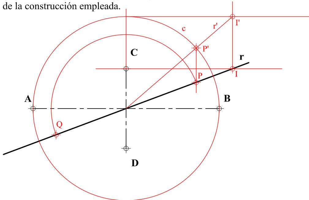
**A2.-** Determinar el ángulo que forma la recta frontal **r** con el plano proyectante horizontal **ABCD**.
