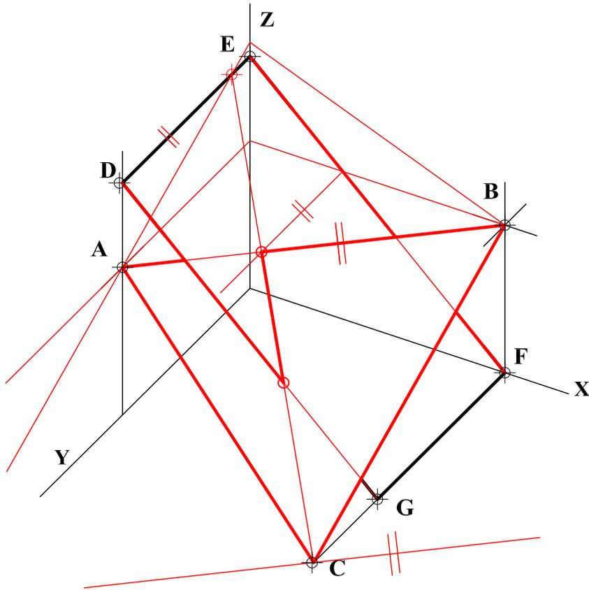
**B4.-** Representar en diédrico, dando las vistas que se consideren necesarias, la pieza cuyo dibujo isométrico se ofrece (sin coeficientes de reducción).
