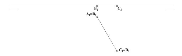
A3.- La pieza de la figura se secciona por dos planos, uno de ellos paralelo al plano YOZ que pasa por el punto A y el otro paralelo al plano XOZ que pasa por el punto B. Dibujar la pieza resultante que contiene al punto C, manteniendo su posición respecto a los ejes. Representar las aristas ocultas.
