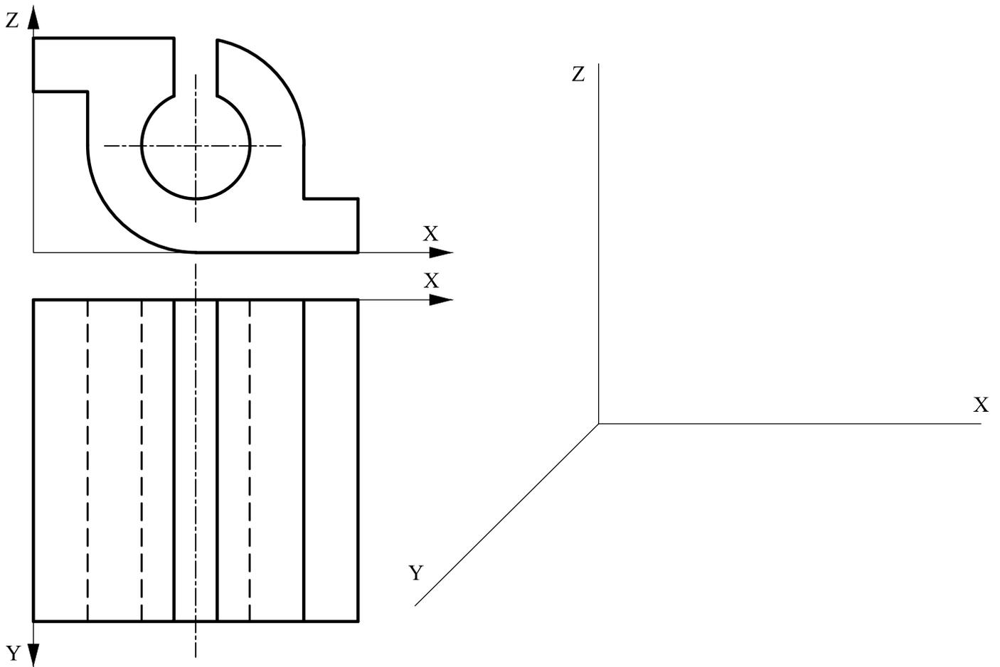
A4.- Dibujar, incluyendo aristas ocultas, las vistas de la pieza representada como *dibujo isométrico* (sin coeficiente de reducción). La figura presenta un plano de simetría.
