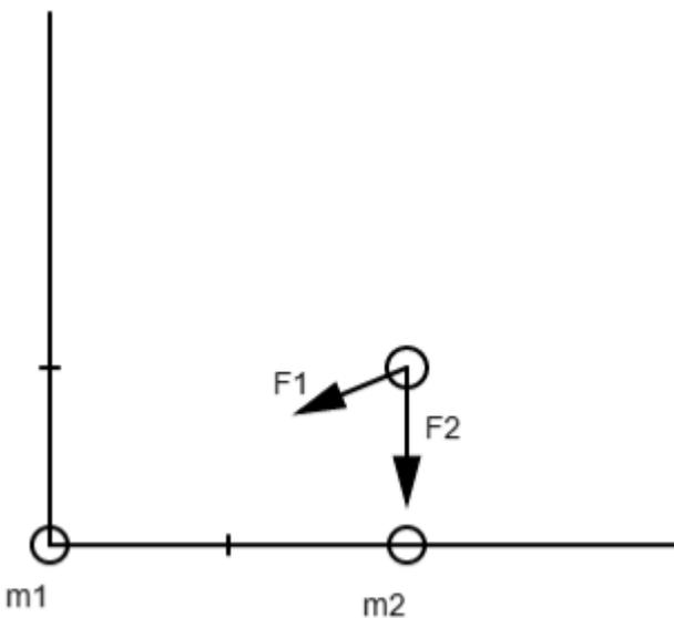
Los módulos se pueden calcular con la ley de gravitación universal,  $F = \frac{GMm}{r^2}$ , obteniendo así  $F_1 = 6,67 \cdot 10^{-10} \text{ N}$ ,  $F_2 = 5 \cdot 10^{-9} \text{ N}$ .
