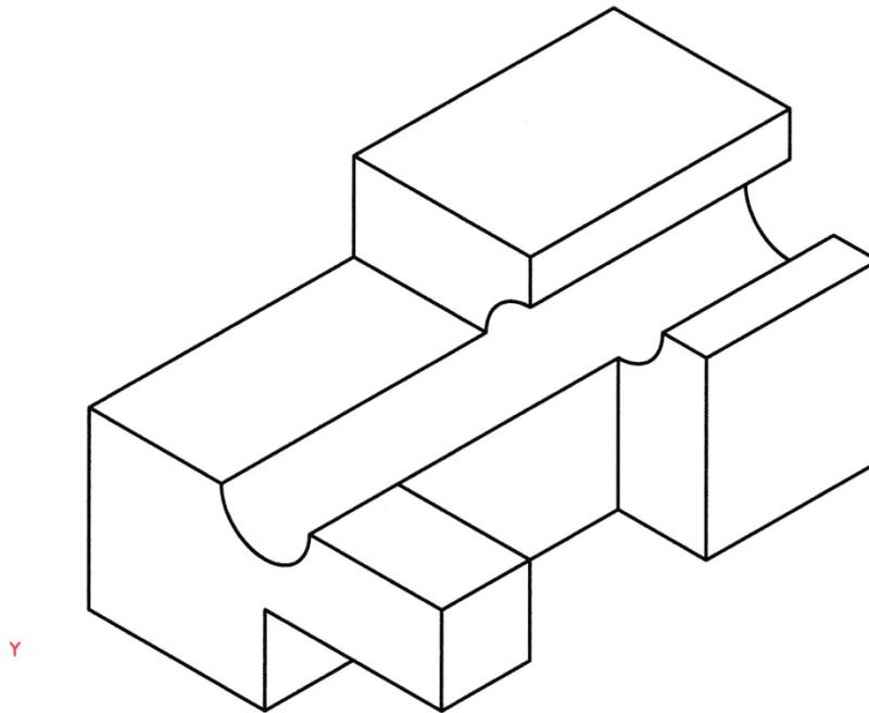
3c) Dada la pieza representada en la figura en sistema diédrico europeo, dibujar a lápiz, y a la escala más apropiada al papel disponible, la perspectiva axonométrica isométrica de la misma. No es necesario tener en cuenta el coeficiente corrector 0,816.
