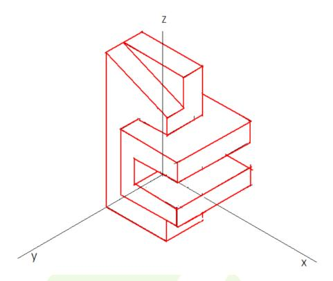
**B4.** Representar las vistas diédricas de la pieza dada en dibujo isométrico (sin coeficientes de reducción) incluyendo un corte por su plano de simetría. Acotar según norma para su correcta definición dimensional, sabiendo que el taladro es pasante.
