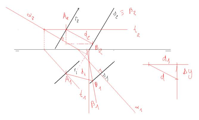
La distancia entre dos rectas paralelas es la distancia de un segmento AB perpendicular a las dos.
