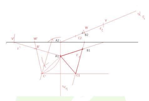
De ahí realizaremos perpendiculares de 30 mm de longitud por  $A_2$ ,  $B_2$  y  $C_2$ , aprovechando que las perpendiculares a un proyectante vertical están en verdadera magnitud. Finalmente haremos paralelas a la base hasta completar la figura:
