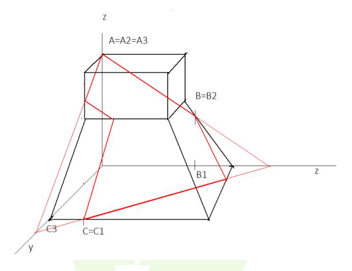
Lo primero es hallar las trazas del plano formado por A, B y C. De ahí podemos hallar los cortes a la figura uniendo los puntos de corte de las trazas con la figura y haciendo paralelas a éstas.
